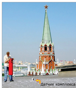
Приложение импульсной нагрузки к зданию Государственного Кремлевского Дворца
